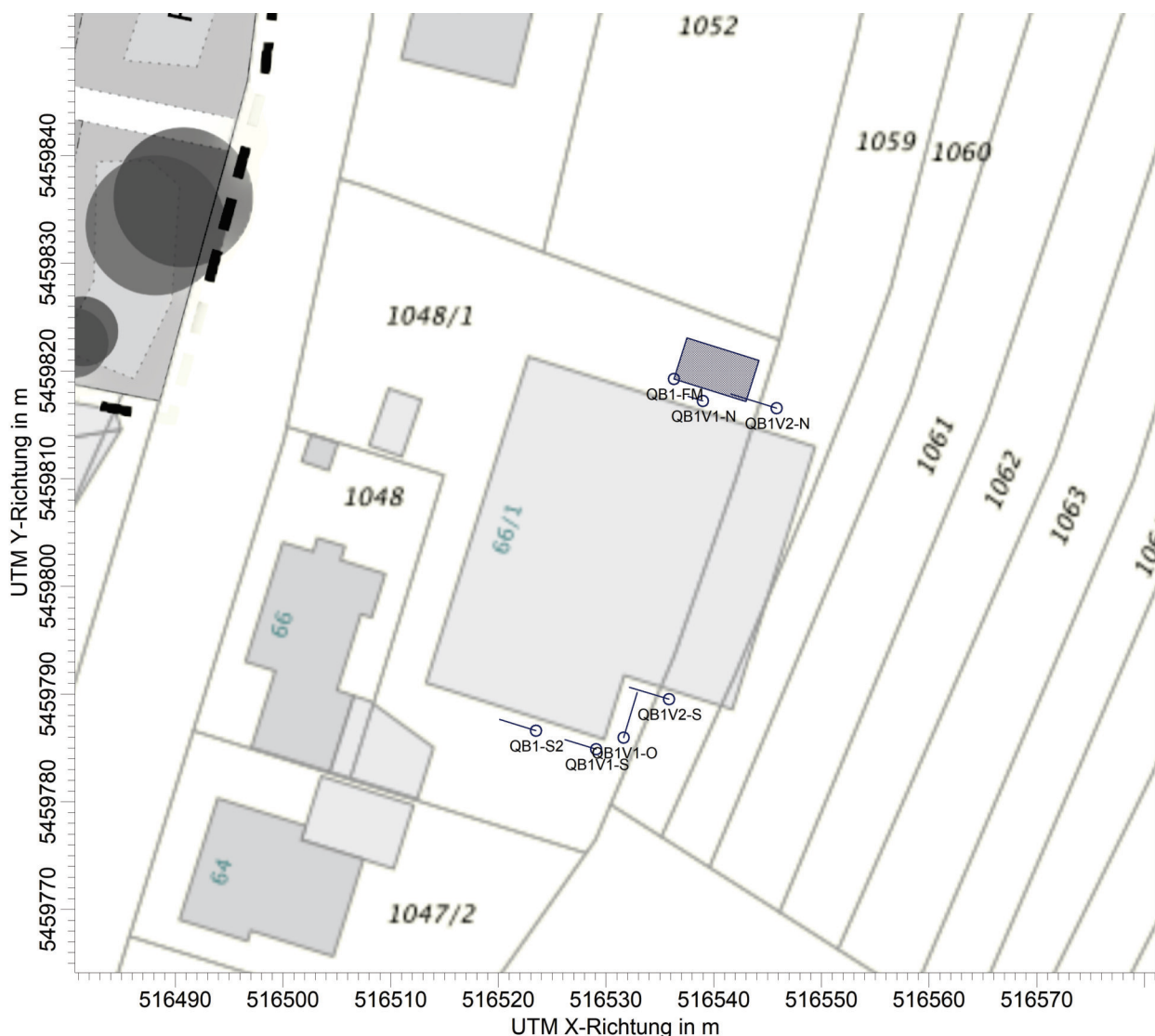
Abbildung A1-1: Übersicht der Emissionsquellen der Tierhaltung auf dem Flst. Nr. 1048/1 in Höchstberg. Die farbigen Markierungen bezeichnen die einzelnen Emissionsquellen, die Abkürzungen entsprechen den verwendeten Bezeichnungen für die einzelnen Quellen bzw. Quell-Bereiche. (Hintergrund: LGL, www.lgl-bw.de , 2024)
